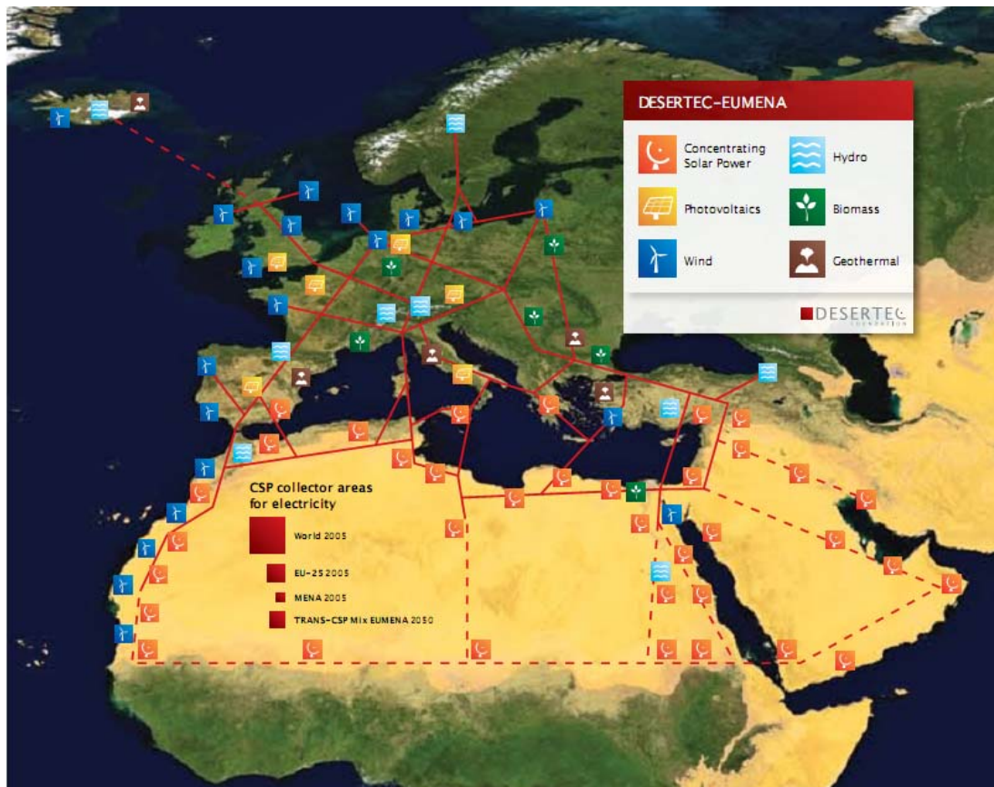
Slika 2.2: Načrt za izgradnjo elektrarn in prenosnega omrežja za proizvodnjo in dobavo elektrike iz OVE znotraj območja EUMENA
