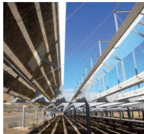
Slika 2.8: Shema linearnega sistema s Frsenelovimi lečami in njegov izgled v naravi
