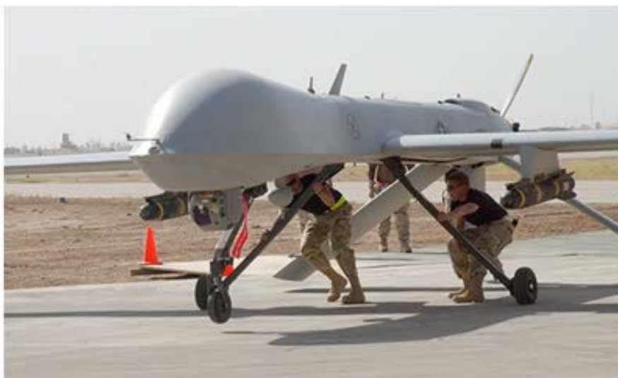
Slika 5: MQ-1 Predator z nameščenima raketama zrak-zemlja AGM114 Hellfire, MALE – razred III
