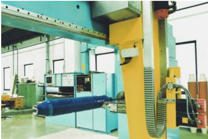
Slika P. 4: Stroj za navijanje vlaken
