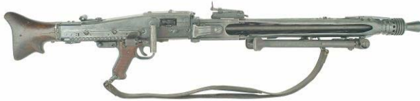
Slika 5.3: nemški mitraljez MG42
