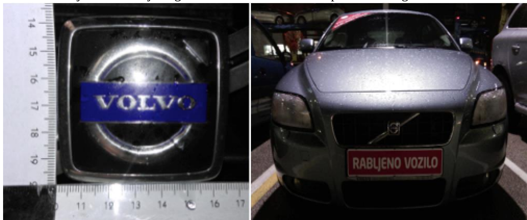
Slika 10: Izmerjene dimenzije loga Volvo na modelu S60 in postavitev loga na vozilu
