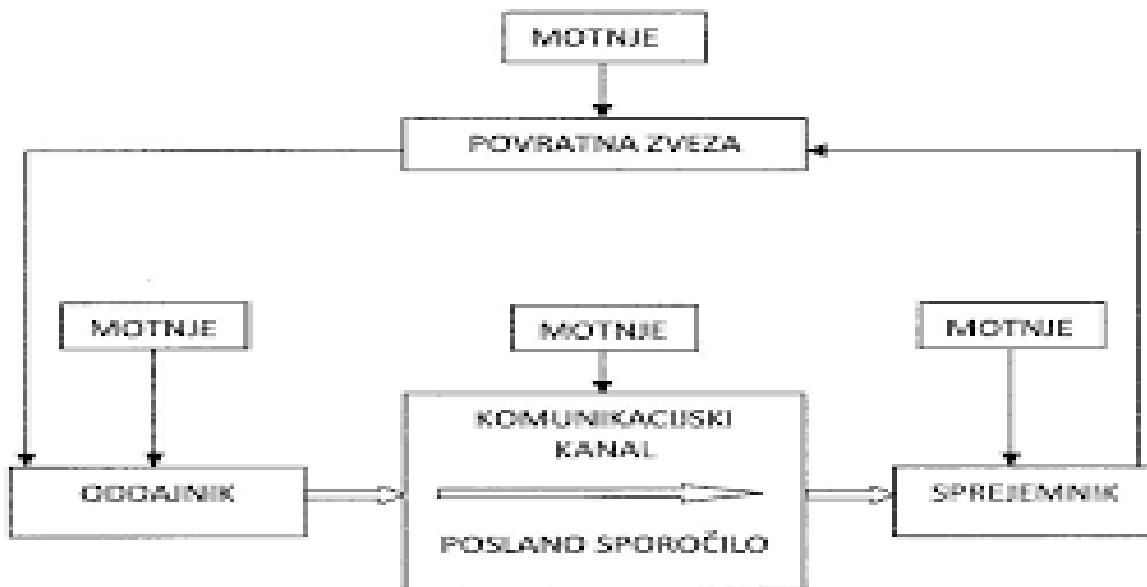
Slika 2.2.: Komunikacijski sistem z motnjami
