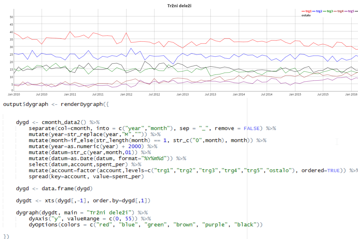
Slika 3.12: Izhodni gradnik za dinamični črtni graf (dygraph) in programska koda
