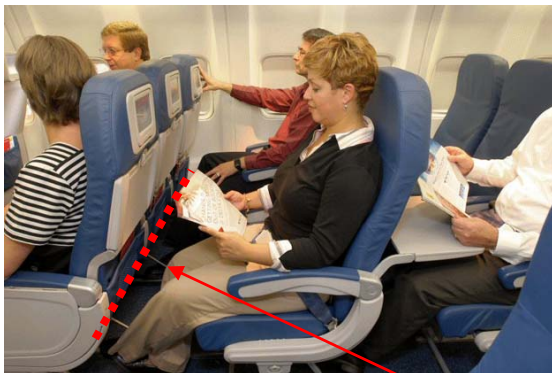
Sliki 6.3.3 in 6.3.4: Sporna kovinska cev v konstrukciji sedeža
