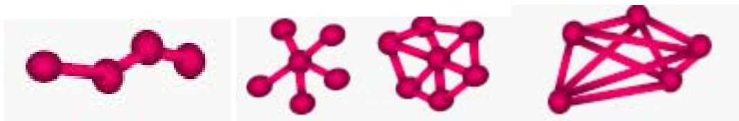
Slika 3.2.3.1: Verižno omrežje; osrednji element omrežja in zvezda; prepleteno omrežje.
