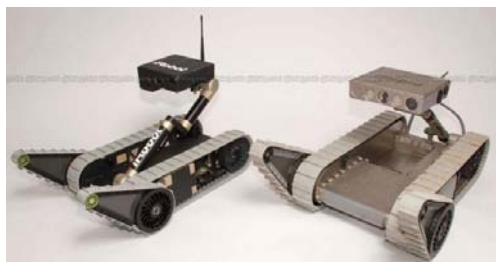
Slika 7.2.2: Primerjava velikosti med PackBotom in SUGV robotom
