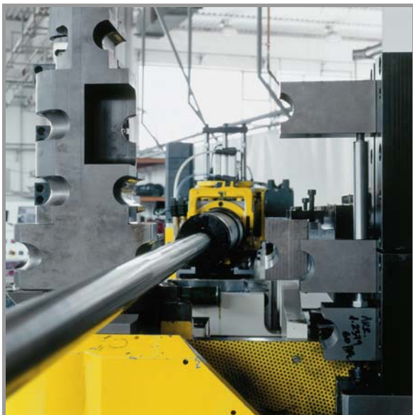
Slika 11: Stroj za upogibanje cevi
