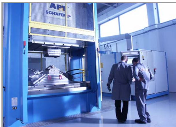
Slika 16: Stroj za hidroforming proces
