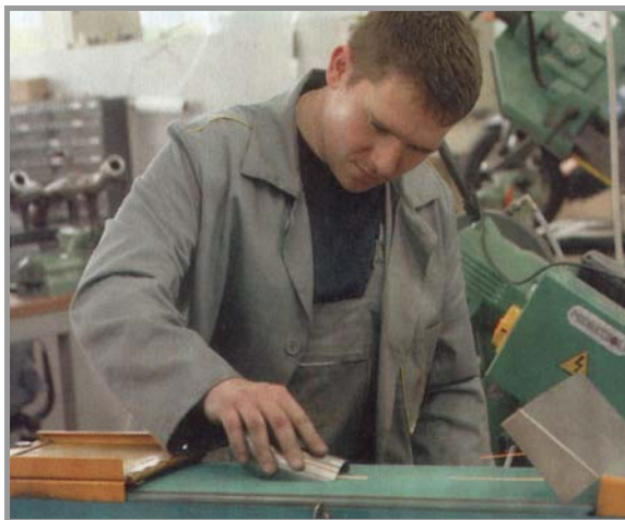
Slika 18: Brušenje robov, da se vsi spoji natančno prilegajo
