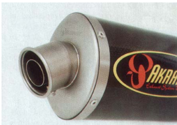
Slika 24: Dodaten dušilec v glušniku lepo viden v notranjosti izpušne cevi
